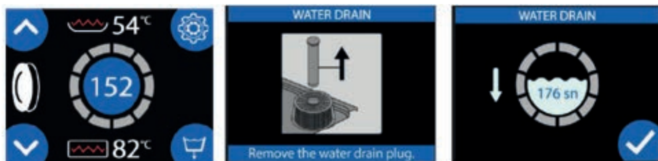
VYPOUŠTĚNÍ VODY. Vyjměte vypouštěcí zátku. (WATER DRAIN. Remove the water drain plug.)
